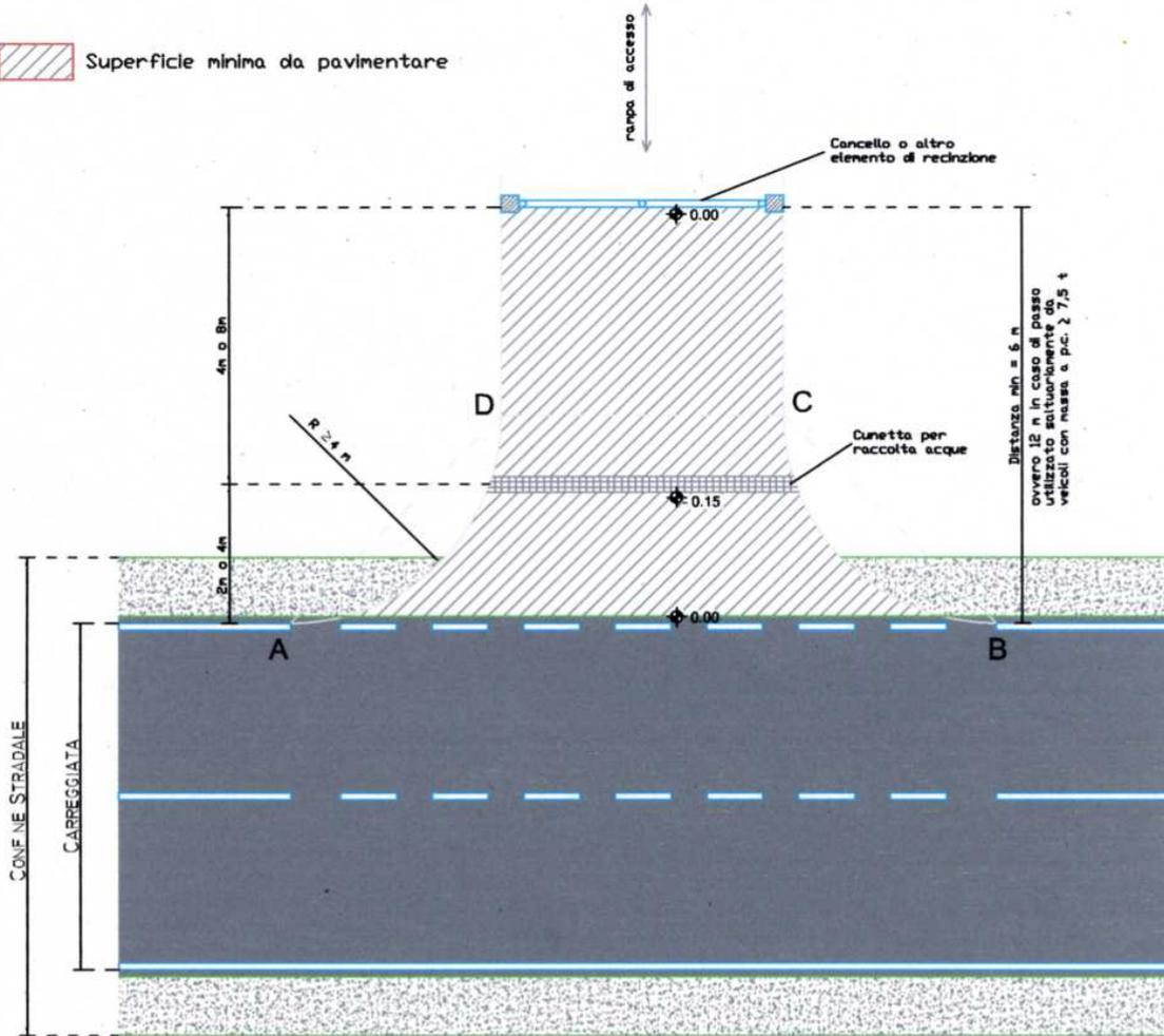
N.B: il vano di accesso dovrà avere una larghezza minima di 3,50 m per edifici o aree di sosta aventi capacità non superiore a 15 posti auto e di 5,00 m nel caso che detta capacità superi i 15 posti auto.
